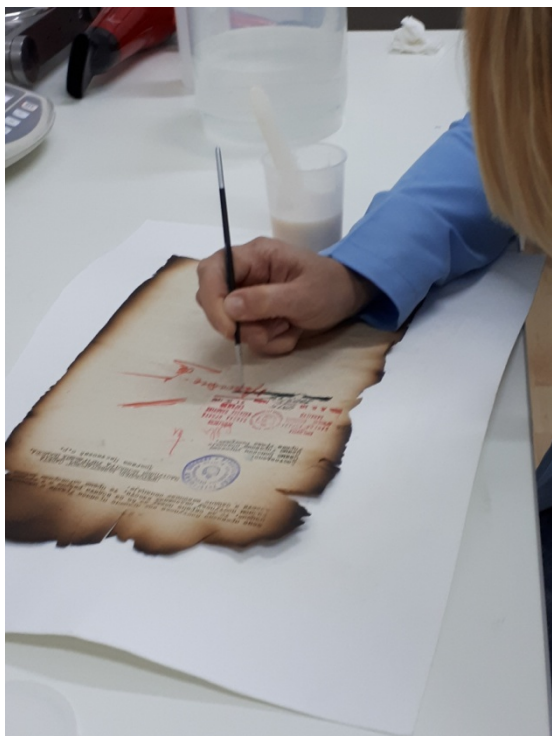
Obr. 6 – aplikace fixativa na dokument
