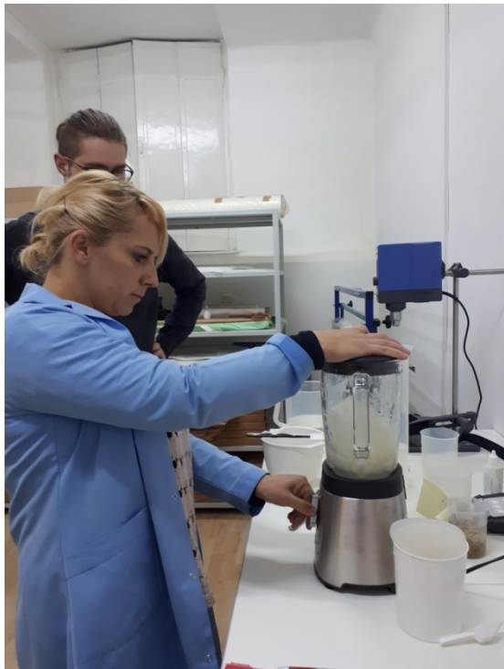
Obr. 3 – příprava papíroviny pro dolévání – mletí
