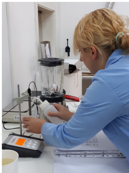
Obr. 2 – kalibrace pH metru pro měření archiválií
